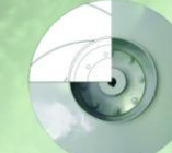
Wirnik zamknięty typu B - łopatkami odgięte do tyłu Closed rotor type B - rear deflected blades geschlossenes Laufrad Typ B rückwärts gebogene Schaufeln
